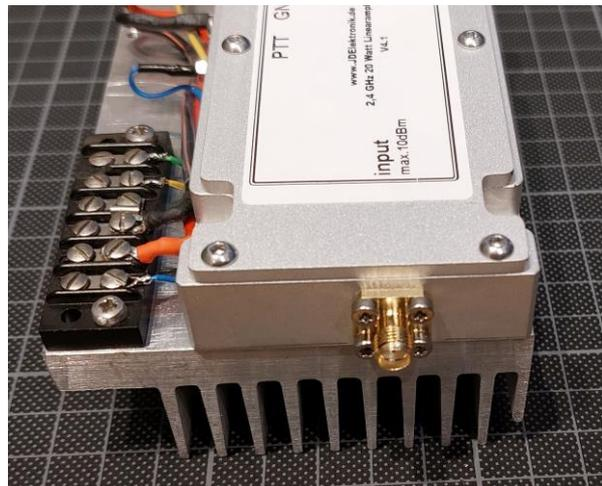
Ich habe die Ausgangsleistung und die Verstärkung des Verstärkermoduls in Abhängigkeit von seiner Eingangsleistung bei 2,4GHz und einer Versorgungsspannung von 28V (intern 27,3V) gemessen. Ich habe zusätzlich die Stromaufnahme gemessen, um den Wirkungsgrad des gesamten Moduls als Funktion der
