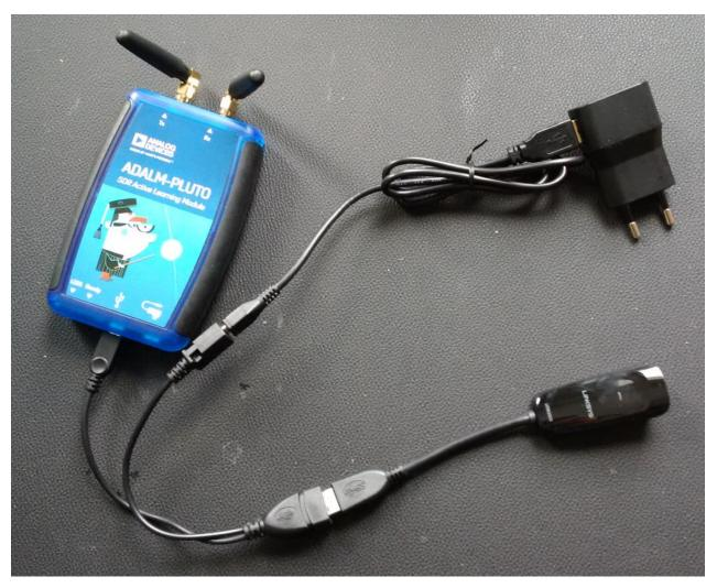
ADALM Pluto (oben links), verbunden über ein USB-OTG-Adapterkabel (unten links) mit einem USB-Ethernet-Adapter (unten rechts). Über den zusätzlichen Anschluss des Y-Kabels werden der USB-Ethernet-Adapter und der Pluto aus einem 5V-Netzteil versorgt.
