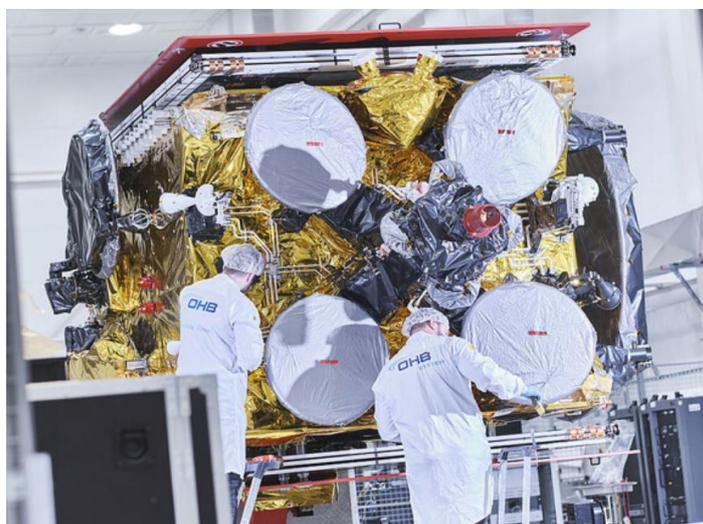
Bild 9: Beispiel des Earthdecks eines SGEOs (Quelle OHB Heinrich Hertz Satellit)
