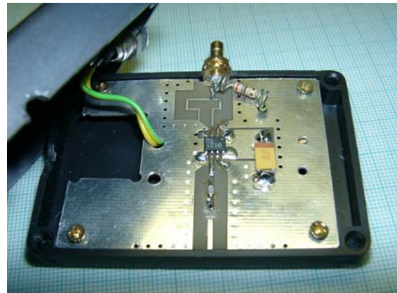
GPS-Repeater: Verstärker im geöffneten Sender. Nicht sicherbar ist die eigentliche Oberseite: auf der Rückseite der Platine ist eine Patchantenne aufgeklebt. Ebenfalls auf der nicht sichtbaren Seite der Platine befindet sich ein 5V Spannungsregler.
