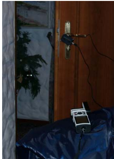
Aufbau: Vorne GPS-Empfänger, hinten an der offenen Türe hängend Sender des GPS-Repeaters, Abstand ca. 1m
