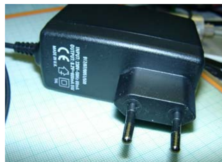
GPS-Repeaterkit: Netzteil V_s = 8.2V DC
