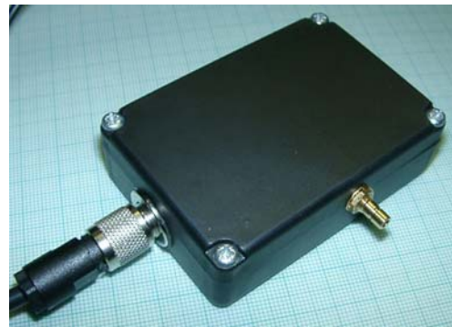
GPS-Repeaterkit: Sender (links Anschluss für Versorgungsspannung, vorne HF-Eingangsbuchse, Oberseite mit Schrauben ist Abstrahlungsrichtung)
