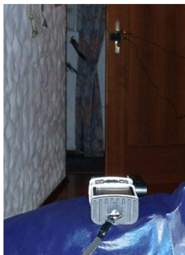
Aufbau: vorne GPS-Empfänger, hinten an der offenen Türe hängend Sender des GPS-Repeaters, Abstand ca. 3m
