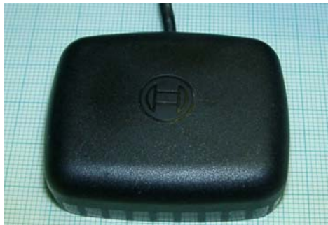
GPS-Repeaterkit: Empfänger (von oben, sollte für optimalen Empfang auch so angeordnet werden)
