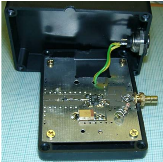
GPS-Repeater: Blick in den geöffneten Sender, rechts an HF-Buchse zum Empfänger befindet sich eine Fernspeiseweiche (Widerstand und Spulen)
