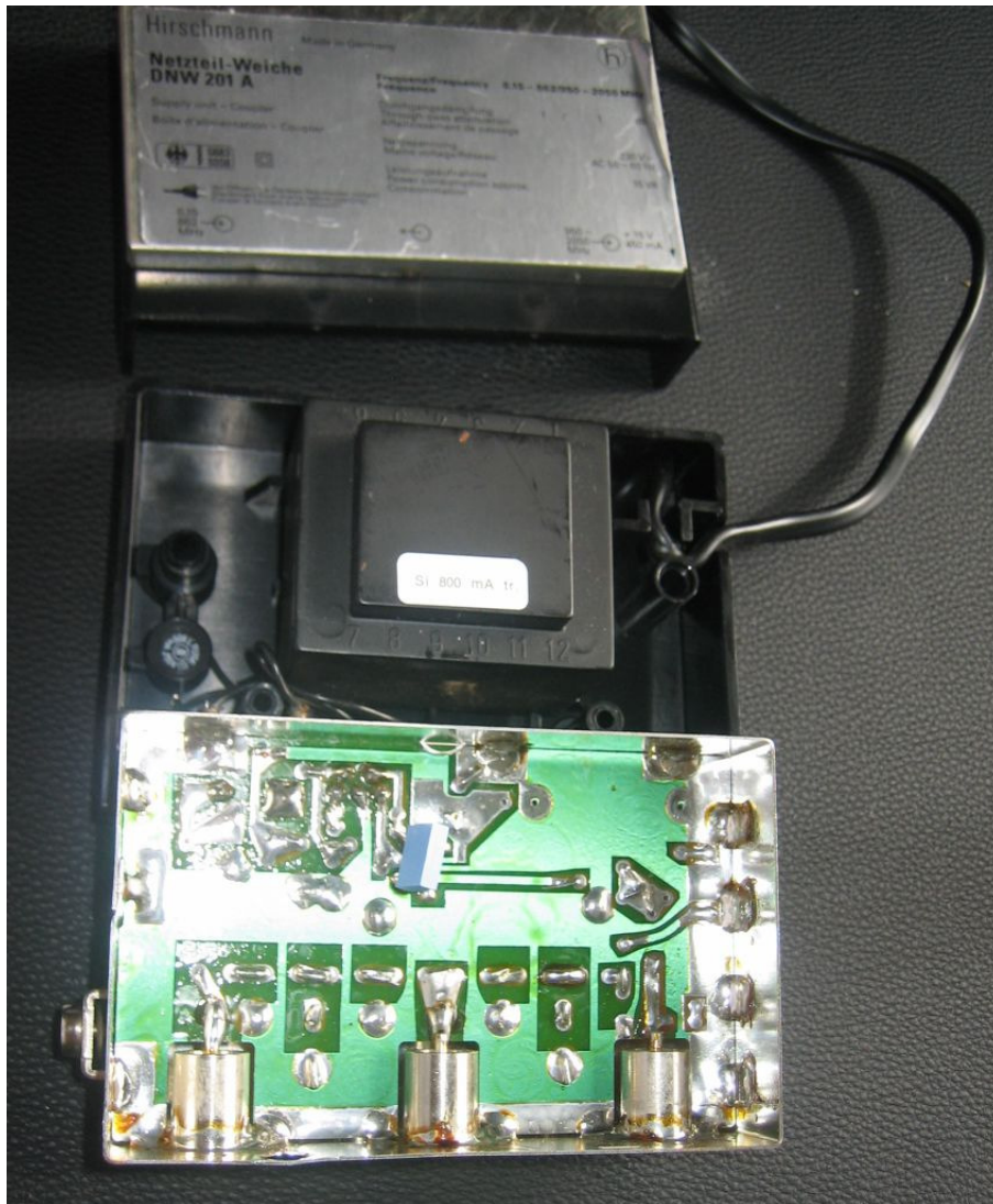
Geöffnetes Gerät, oben Trafo, unten geöffnetes Weissblechgehäuse
