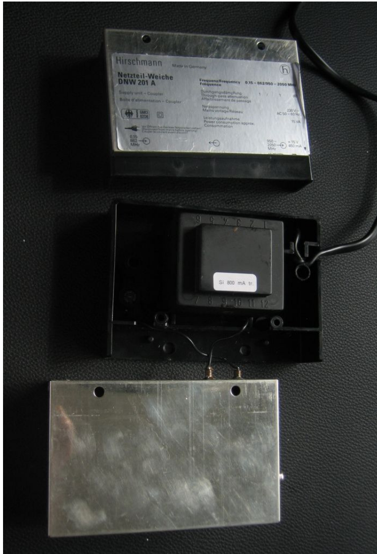
Geöffnetes Gerät, oben Trafo, unten geschlossenes Weissblechgehäuse
