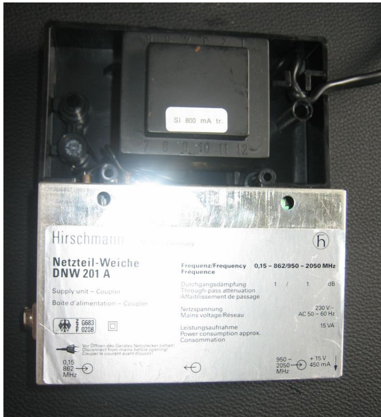
Geöffnetes Gerät, oben Trafo, unten geschlossenes Weissblechgehäuse
