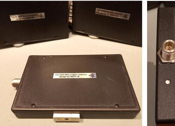
Anschließend habe ich noch die Anpassung der Logper Antenne im Frequenzbereich 50kHz bis 3 Ghz gemessen. Die Antenne wurde dabei aus einem offenen Fenster nach Außen gerichtet um Reflexionen im Raum zu vermeiden.
