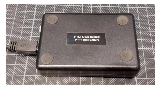
Bei der von mir verwendeten Platine war es nicht nötig, einen Pull-Up-Widerstand zwischen dem DSR-Pin und der Versorgungsspannung einzufügen. Möglicherweise ist es bei anderen Platinen/Chipsätzen nötig einen solchen einzulöten, ich denke ca. 10kOhm sollte ein guter Wert sein.
