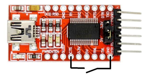
Die Platine wird über die USB-Schnittstelle mit Strom versorgt und man muss nun einfach nur die Pins CTS oder DSR mit GND verbinden, so lange man Senden möchte. Im Bild oben ist dies für die Verwendung des CTS-Pins skizziert.
