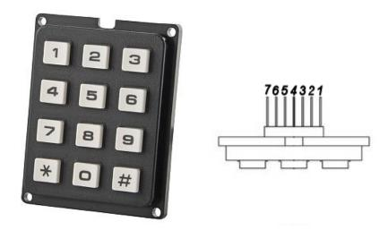
Die Auswertung der Tastaturmatrix und Kommunikation mit dem Transceiver übernimmt ein 8bit Mikrokontroller des Typs ATMEL AVR AT90S2313P. Die Stromversorgung mit +5V DC erfolgt direkt aus der Mikrofonbuchse. Hier das Schaltbild welches gegenüber der Originalschaltung von Peter nur leicht verändert wurde (5V Spannungsregler entfällt, Leuchtdiode zur Anzeige der aktivierten Tastatur).
