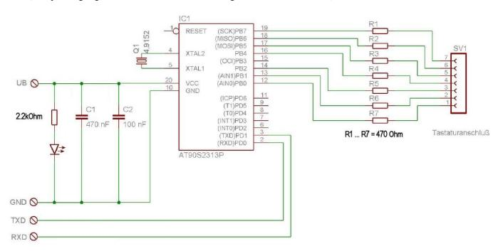
Ich habe die Signale UB=5V, GND, TXD und RXD über einen 4 poligen Einschalter mit dem 8 poligen Westernstecker verbunden. Über den 4 poligen Schalter kann ich somit die komplette Schaltung vom Mikrofonkabel abtrennen, wenn ich beispielsweise ein Fernsteuermikrofon wie das YAESU MH-59 verwenden möchte.
