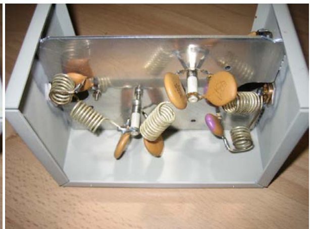
Versteiltes Dreifach-Tiefpassfilter als Nutzpfad
