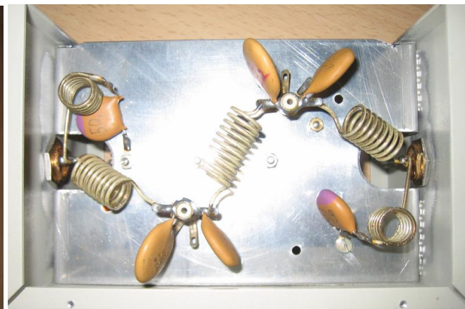
Versteiltes Dreifach-Tiefpassfilter als Nutzpfad
