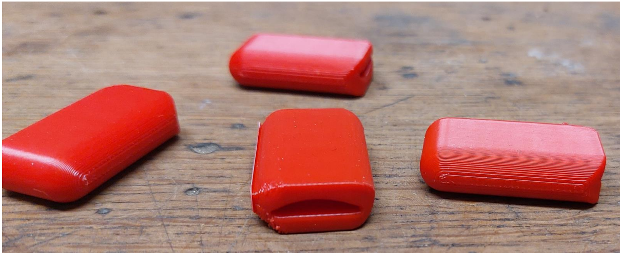
Bild 9: 3D-gedruckte Endkappen für die Maßbandelemente
