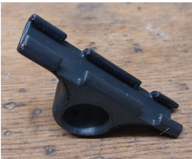
Bilder 4-8: 3D-gedruckte Elementhalter für Strahler, Reflektoren und Direktor
