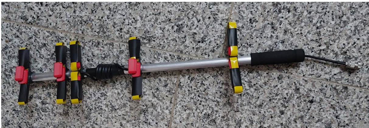
Bild 19: Antennenelemente zum Transport und zur Lagerung aufgerollt.
