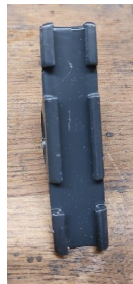
Bilder 4-8: 3D-gedruckte Elementhalter für Strahler, Reflektoren und Direktor
