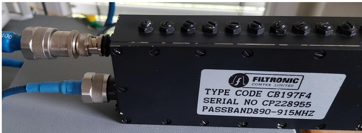
Messaufbau zur Bestimmung der Koppeldämpfung. Dabei war der Ausgang mit 50 Ohm abgeschlossen.
