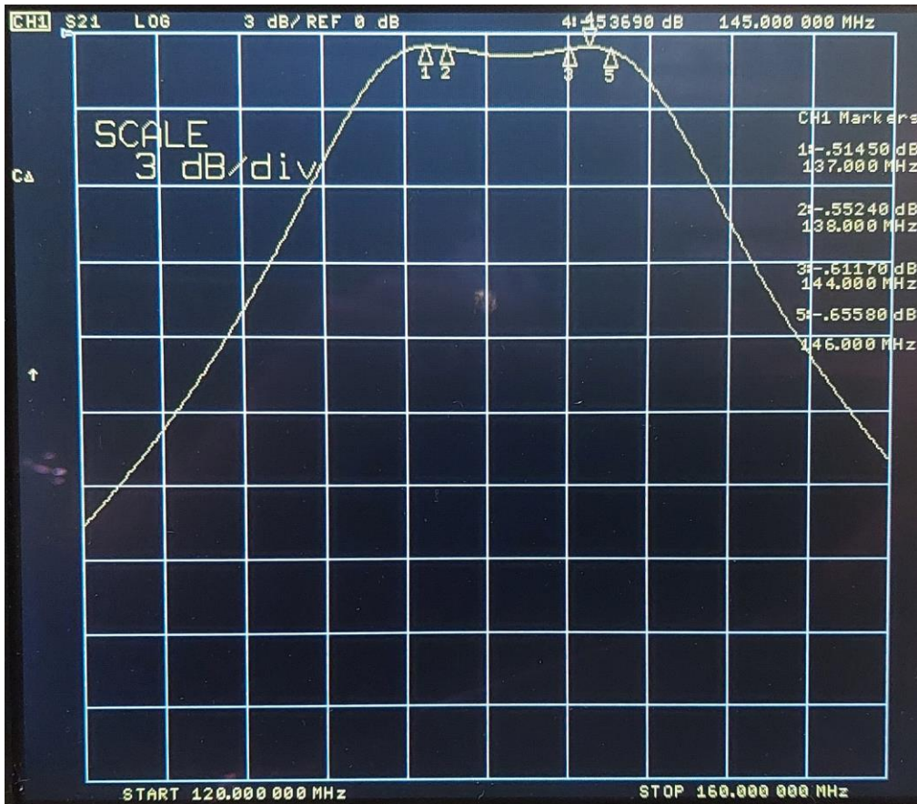
Durchgangsdämpfung S21 im Frequenzbereich 120 bis 160 MHz. Die Durchgangsdämpfung beträgt bei bei 137 MHz nur 0.51 dB, bei 145 MHz 0.54 dB.
